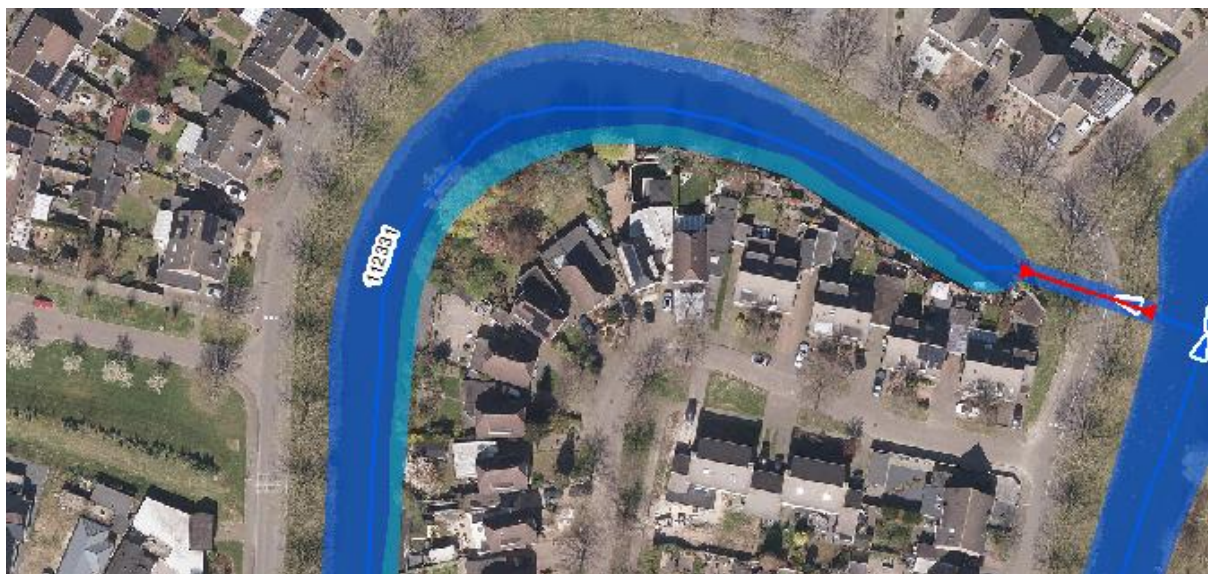
Figuur 2.1: Een primair water met een secundair water langs de oever ingetekend in de waterschapsverordening. Het onderhoud van het secundaire water is voor de aanliggend eigenaar.
